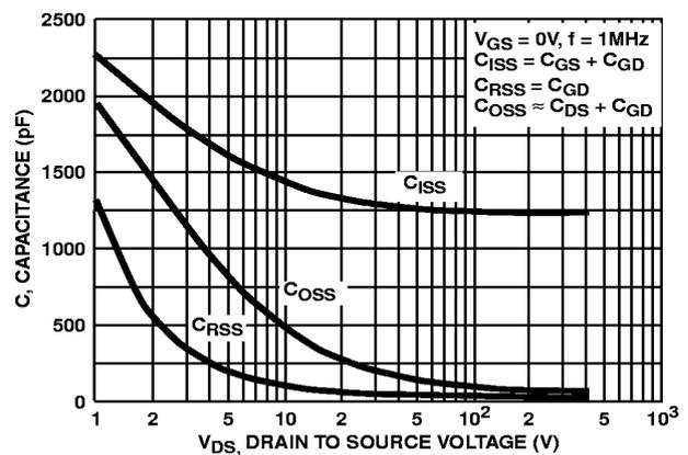
FIGURE 11. CAPACITANCE vs DRAIN TO SOURCE VOLTAGE
