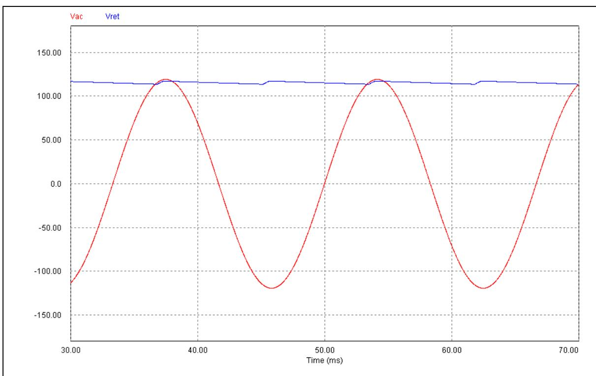
Figura 7 - Formas de onda da tensão de entrada e da tensão na saída do retificador com tensão mínima de entrada em Malha Aberta
