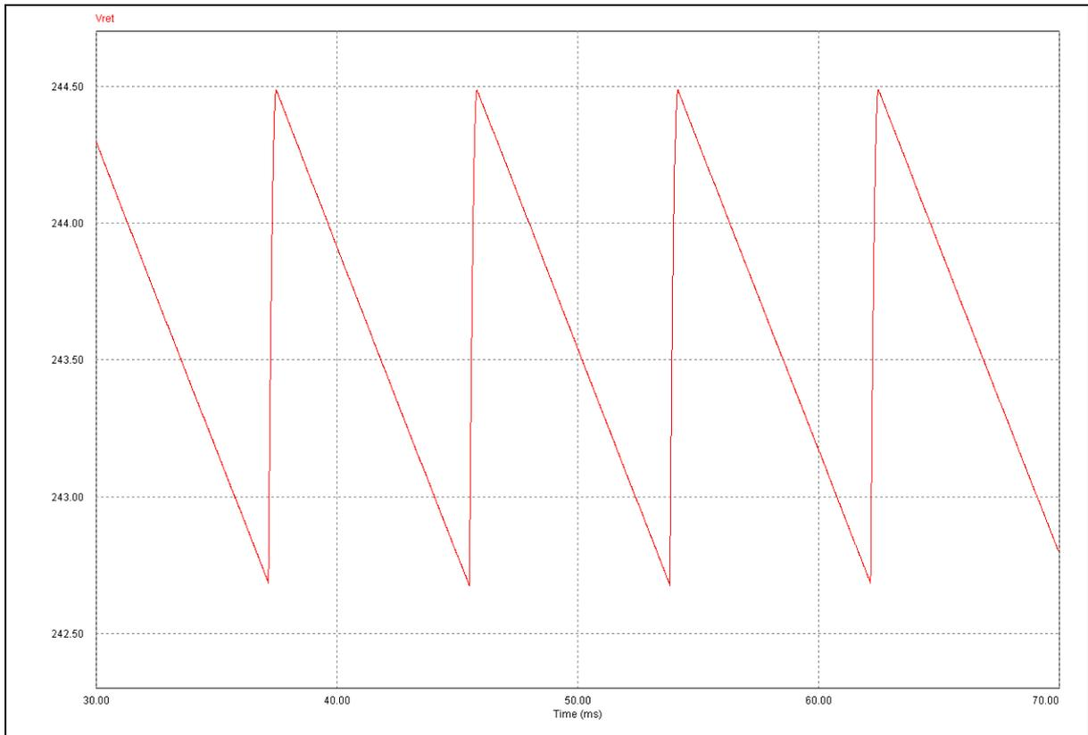
Figura 18 - *Ripple* da forma de onda da tensão na saída do retificador com tensão média de entrada em Malha Aberta
