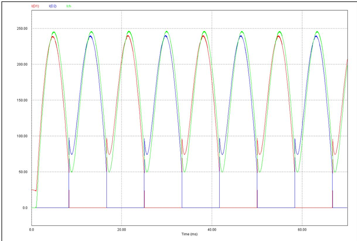
Figura 22 - Formas de onda das correntes em dois diodos retificadores e da corrente na chave, em Malha Fechada
