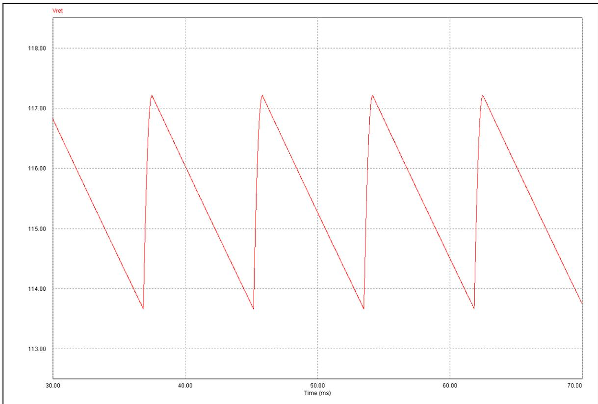
Figura 8 - *Ripple* da forma de onda da tensão na saída do retificador com tensão mínima de entrada em Malha Aberta
