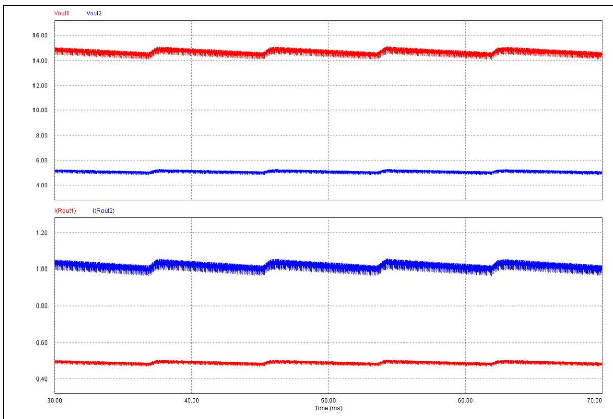
Figura 10 - Formas de onda das tensões e correntes nas duas saídas, com tensão mínima de entrada em Malha Aberta
