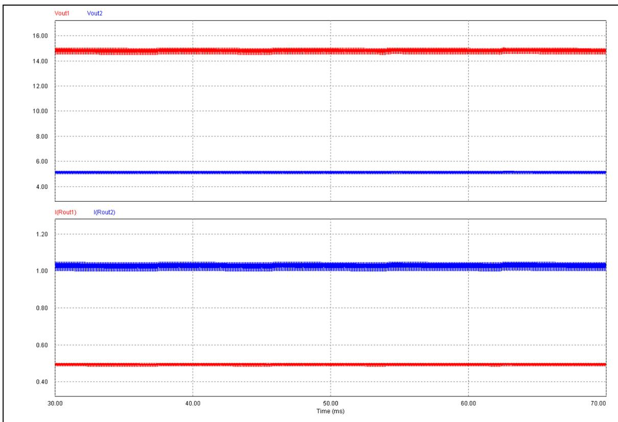
Figura 15 - Formas de onda das tensões e correntes nas duas saídas, com tensão máxima de entrada em Malha Aberta
