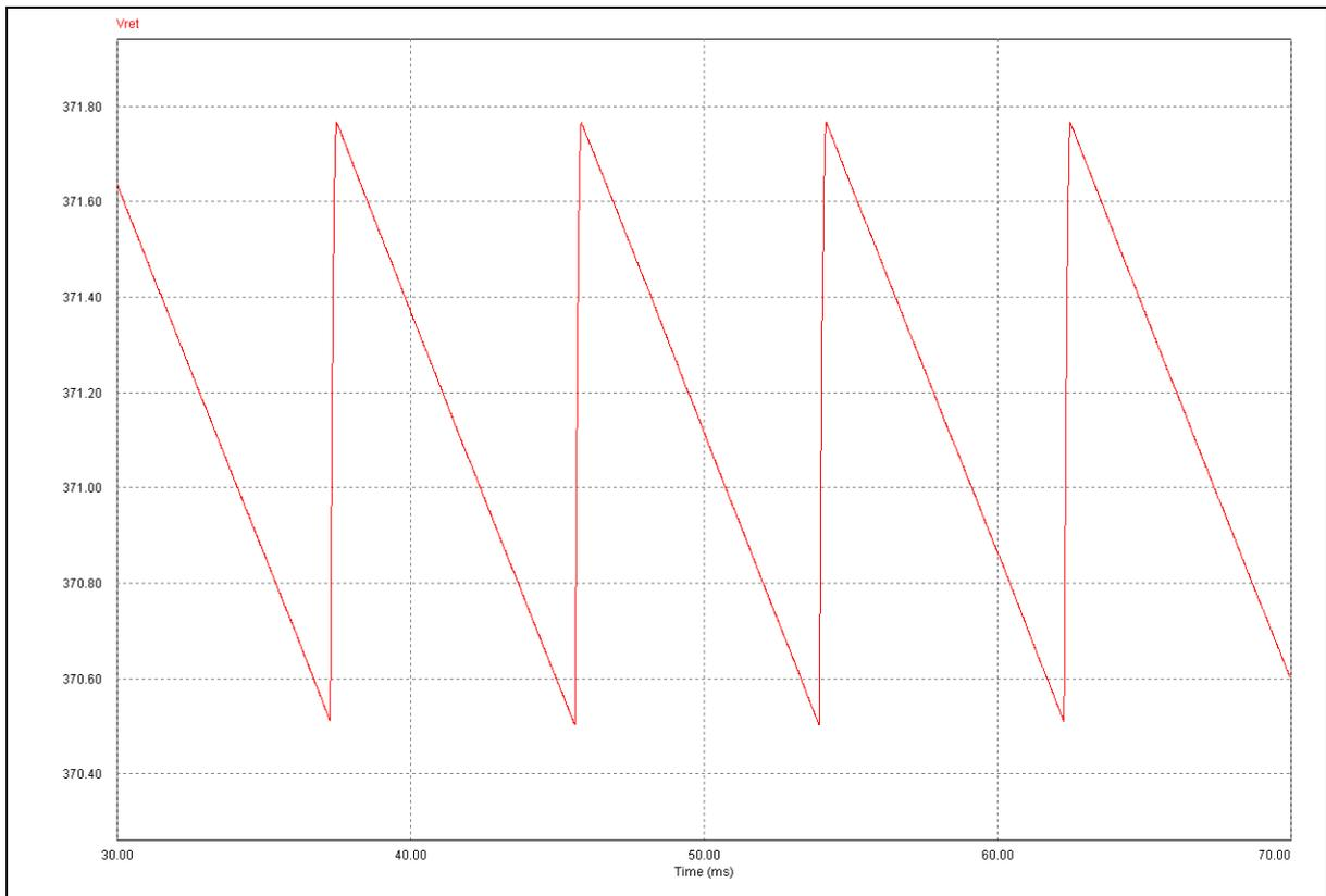
Figura 13 - *Ripple* da forma de onda da tensão na saída do retificador com tensão máxima de entrada em Malha Aberta
