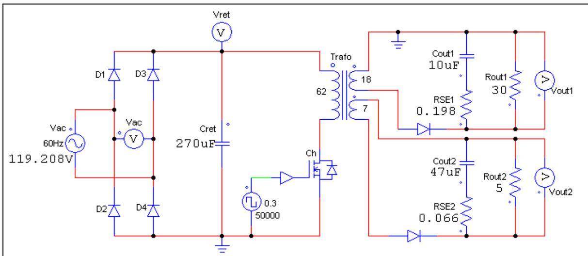
Figura 6 - Circuito para simulação com tensão mínima de entrada em Malha Aberta
