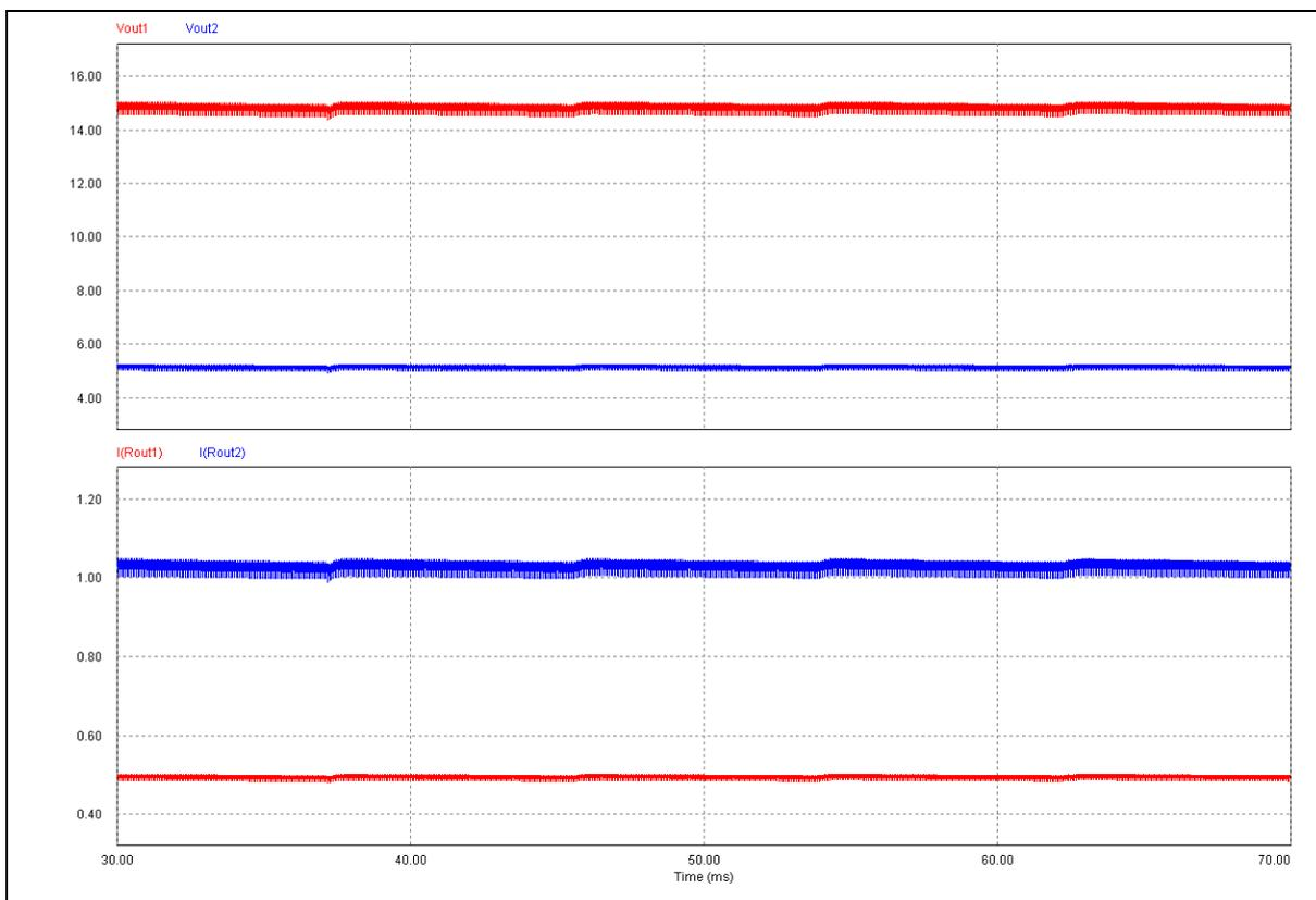
Figura 20 - Formas de onda das tensões e correntes nas duas saídas, com tensão média de entrada em Malha Aberta
