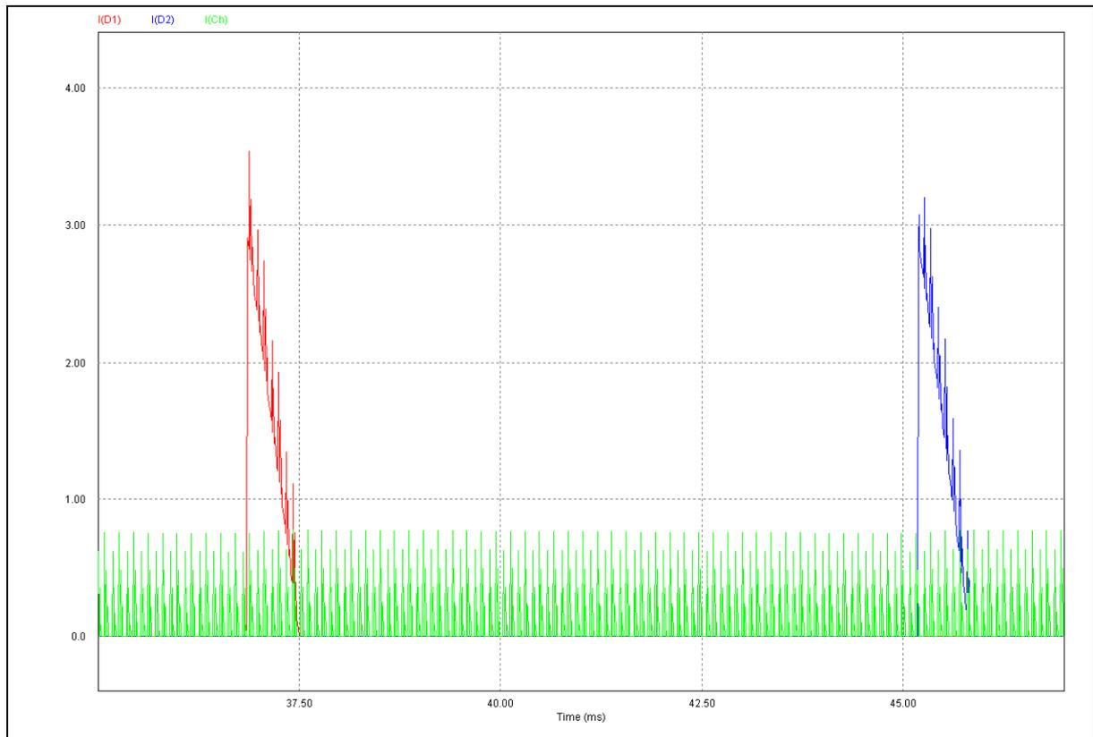
Figura 9 - Ampliação das formas de onda das correntes em dois diodos retificadores e da corrente na chave, com tensão mínima de entrada em Malha Aberta
