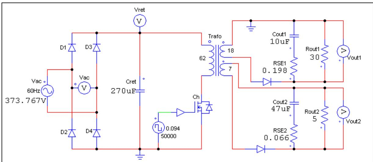
Figura 11 - Circuito para simulação com tensão máxima de entrada em Malha Aberta
