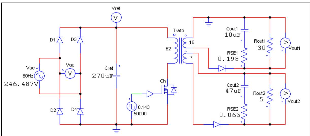
Figura 16 - Circuito para simulação com tensão média de entrada em Malha Aberta
