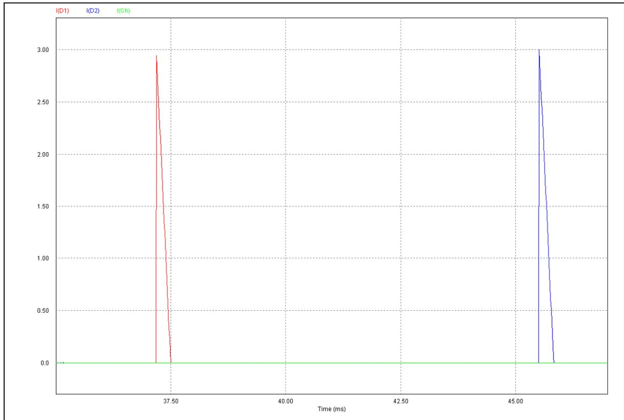
Figura 19 - Ampliação das formas de onda das correntes em dois diodos retificadores e da corrente na chave, com tensão média de entrada em Malha Aberta
