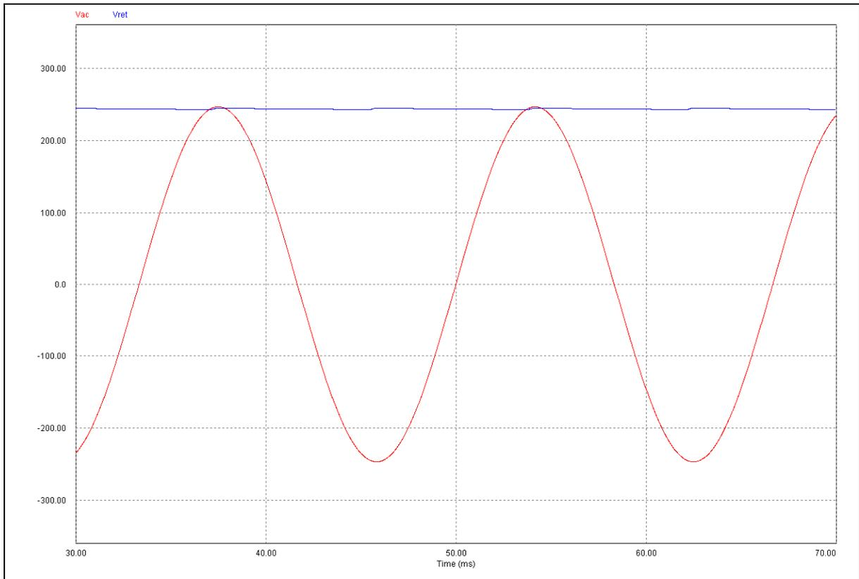
Figura 17 - Formas de onda da tensão de entrada e da tensão na saída do retificador com tensão média de entrada em Malha Aberta
