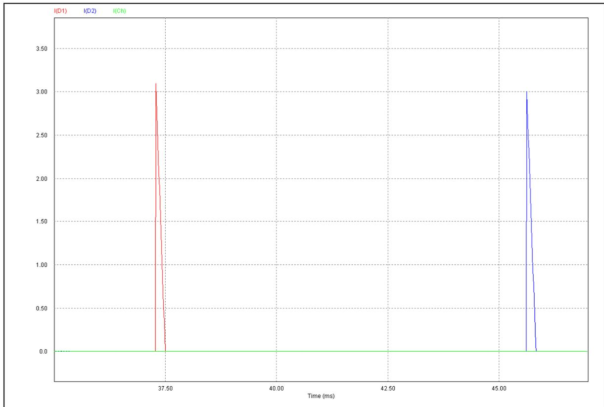
Figura 14 - Ampliação das formas de onda das correntes em dois diodos retificadores e da corrente na chave, com tensão máxima de entrada em Malha Aberta
