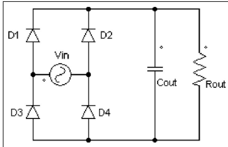
Figura 2 - Projeto do Circuito Retificador, com filtro capacitivo
