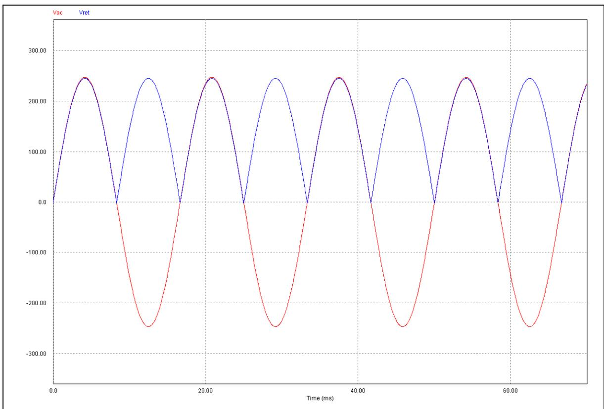
Figura 21 - Formas de onda da tensão de entrada e da tensão na saída do retificador em Malha Fechada
