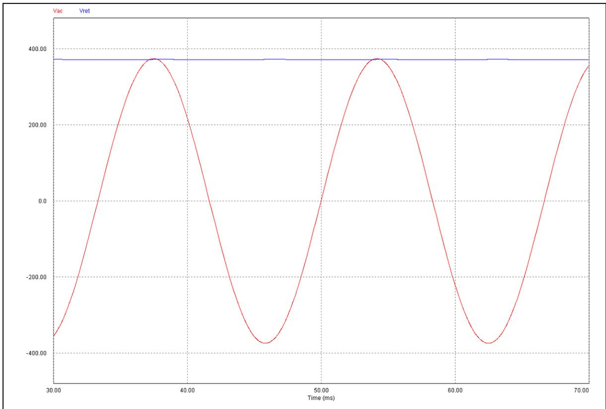
Figura 12 - Formas de onda da tensão de entrada e da tensão na saída do retificador com tensão máxima de entrada em Malha Aberta
