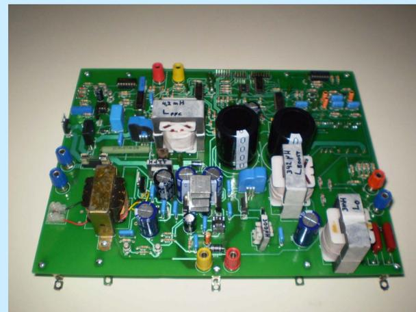
Fig. 5- PCI para pré-regulador PFC e Inversor Monofásico.
