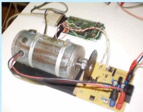
Fig. 1- Sistema de controle do motor CC.
