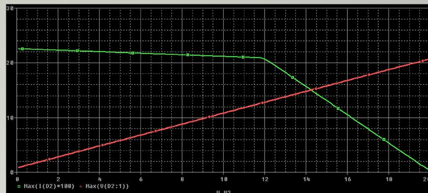
Figura 3. Relação de tensão e corrente(x100) do painel
