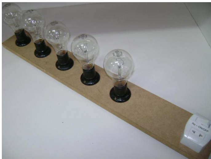
FIGURA 56 – Banco de Cargas (1000 watts)
