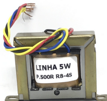
Figura 16 – Transformador para casamento de impedância.
