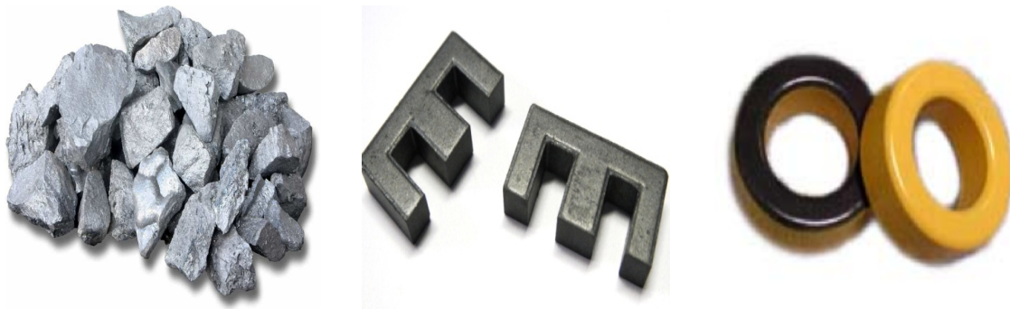
Figura 15 – Materiais magnéticos empregados para construção de dispositivos eletromagnéticos.
