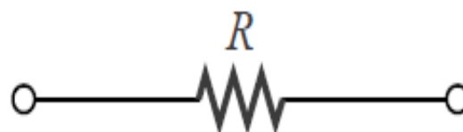
Figura 3.1 Símbolo da resistência e sua abreviação.
