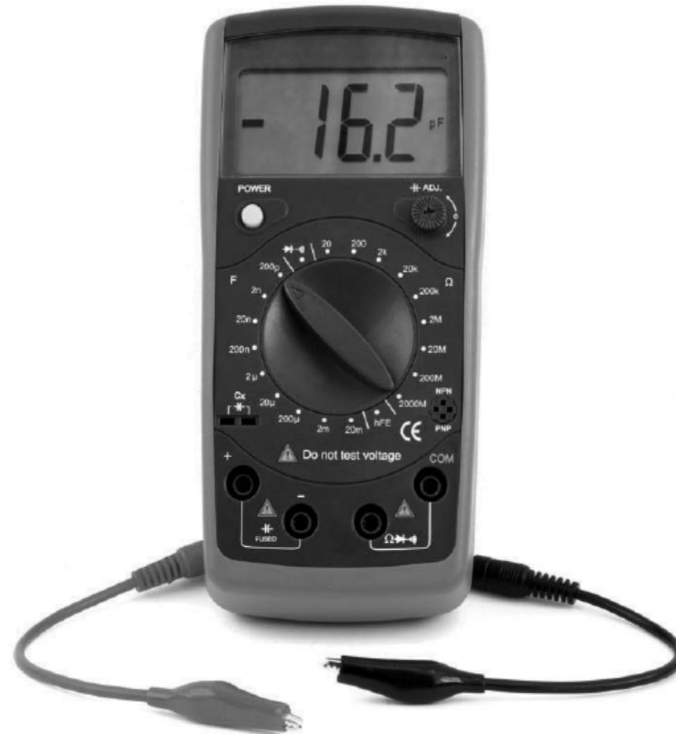
**Figura 10.24** Medidor digital da capacitância. (Cortesia de oksana2010/Shutterstock.)
