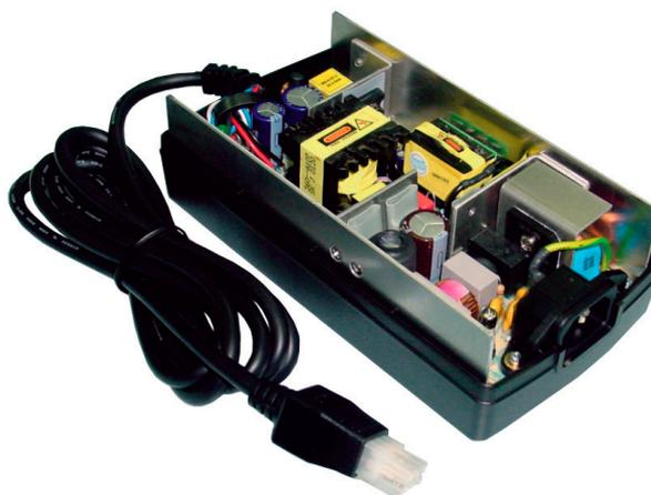
Figura 10 – Exemplo de fonte chaveada comercial.
