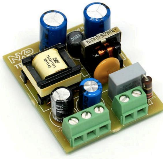
Figura 1 – Exemplo de conversor cc-cc Flyback comercial.
