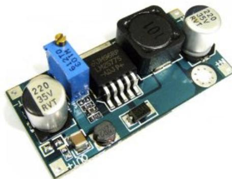
Figura 16 – Conversor cc-cc elevador com LM2577.
