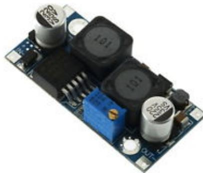
Figura 15 – Conversor cc-cc abaixador com LM2575.
