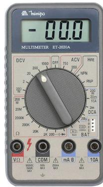
Figura 14 – Multímetro digital para teste de diodos.
