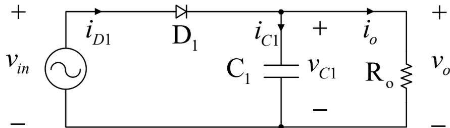
Figura 1 – Circuito do retificador monofásico de meia onda.
