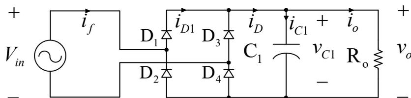
Figura 3 – Circuito do retificador monofásico de onda completa em ponte.
