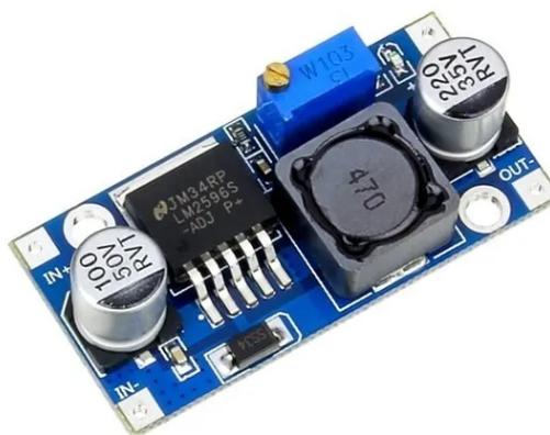
Figura 2 – Exemplo de conversor cc-cc Buck comercial.
