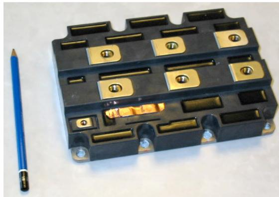
Figura 30 – Aspecto de um módulo de IGBTs para alta potência.
