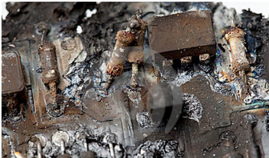
*Figura 1 – Placa de um circuito eletrônico danificada.*
