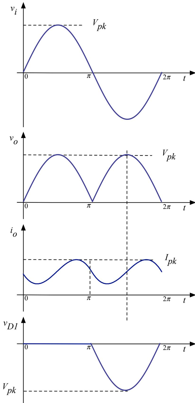
Figura 4 – Principais formas de onda do retificador monofásico de onda completa em ponte com carga resistiva-indutiva.
