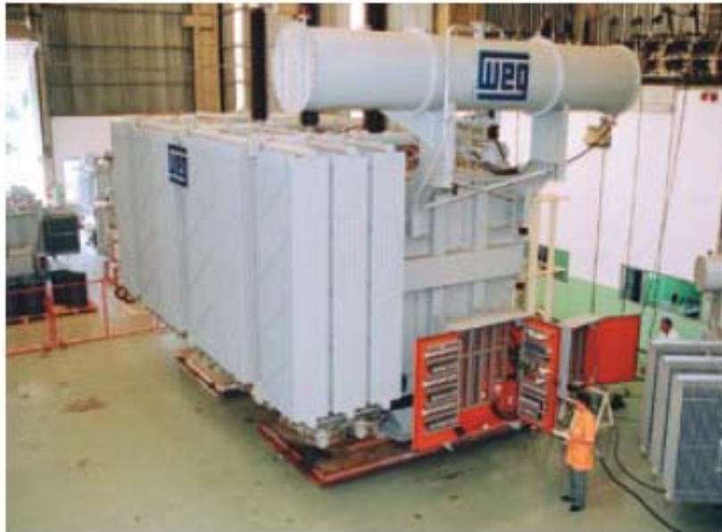
GE Hydro - Usina Campos Novos Transformador 311 MVA - 242 kV (4 peças)
